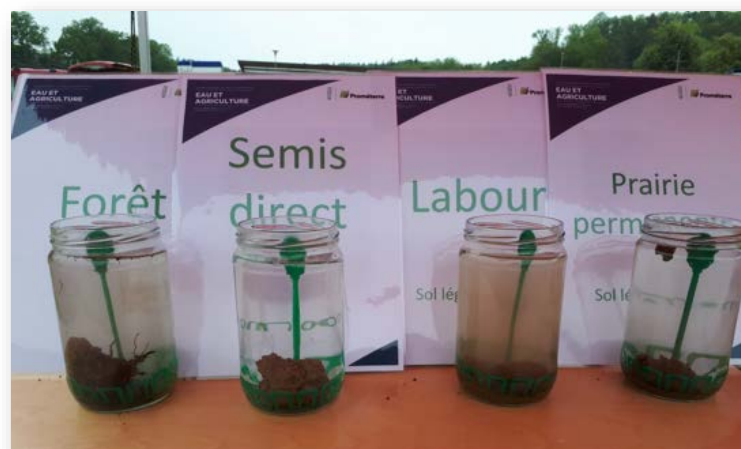
Test de la stabilité structurale
